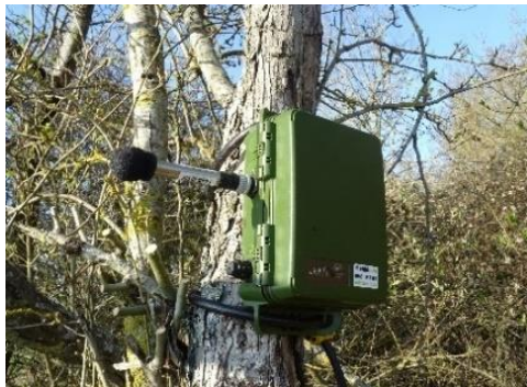
Photo 17 : Détecteur d'ultrasons utilisé lors de l'étude
