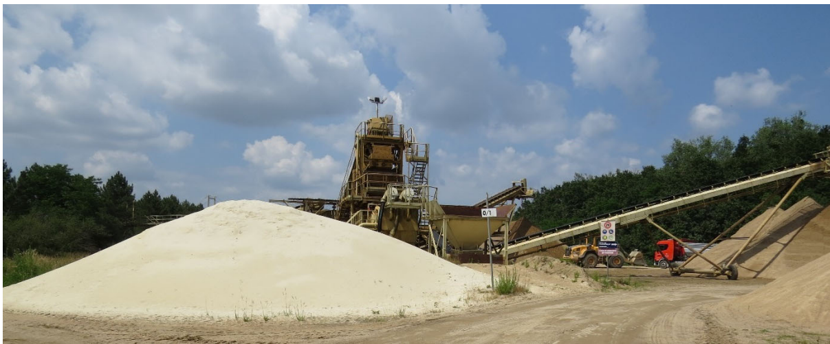
Les installations de traitement fixes permettant le tri mécanique (criblage) et le lavage des matériaux.
