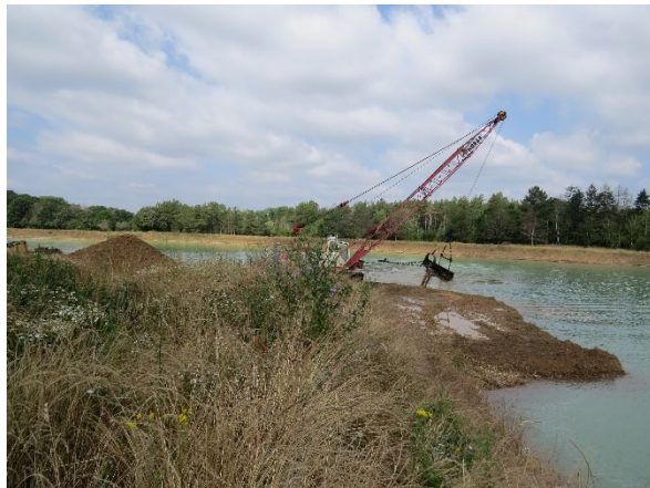
Extraction du secteur Ouest à la dragueline
