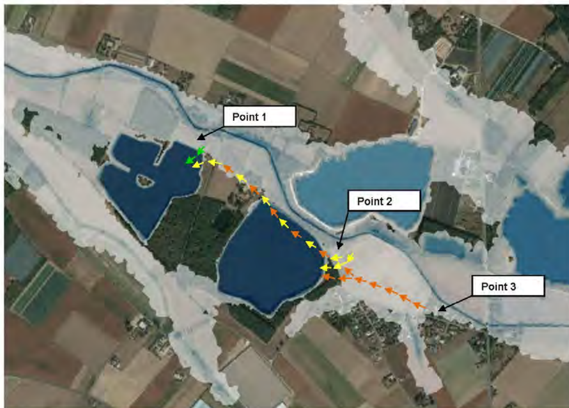
Figure 29 : Points de débordements et chemins d'écoulement des eaux
