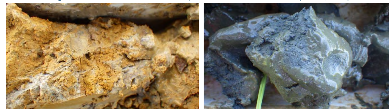
Photo 2 : Exemples de traces rédoxiques à gauche et d'un horizon réductique à droite
