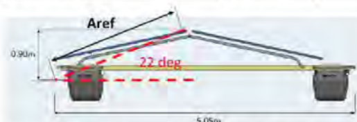
Figure 9 : Schéma pour le calcul de la surface Aref
