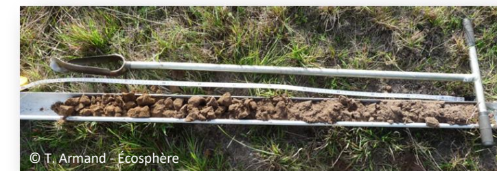
Figure 36 : Sondage pédologique à la tarière manuelle
