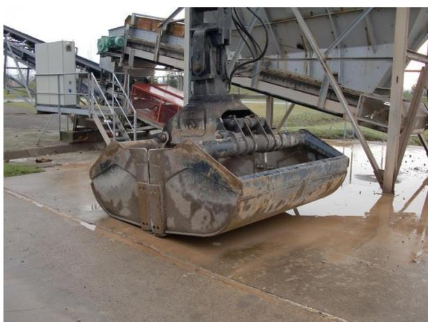
Figure 7 : Illustration d'un godet obturable
