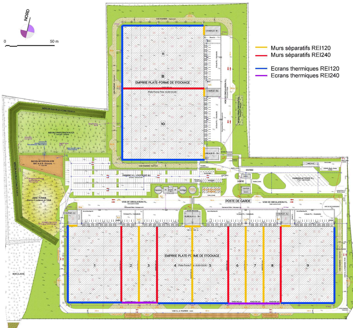
Figure 22 : Localisation des murs séparatifs et écrans thermiques
