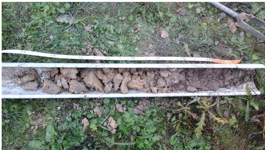
Sondage n°2 : sondage humide dans la friche post-culturelle. Les traces rédoxiques sont présentes en dessous de 50 cm et s'intensifient en profondeur à gauche sur la photo, avec apparition de traces réductrices observées à partir de 80 cm.
