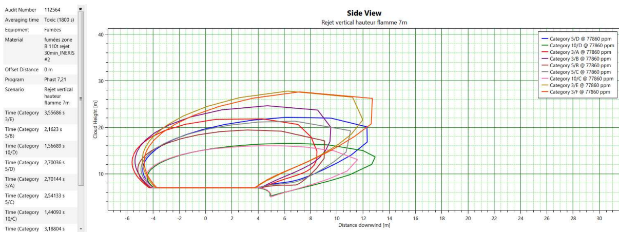
Figure 82 : PhDM22, incendie généralisé zone B configuration définitive, panaches toxiques, émission 30 minutes
