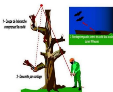
Schéma présentant les précautions à prendre en cas d'abattage par démontage manuel assisté (© BIOTOPE)
