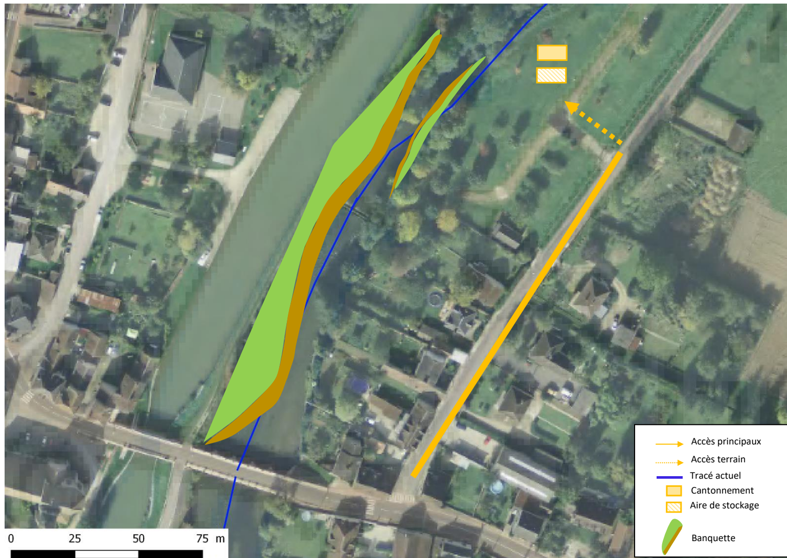
Figure 18 : Accès et installations de chantier sur le site de Montbouy
