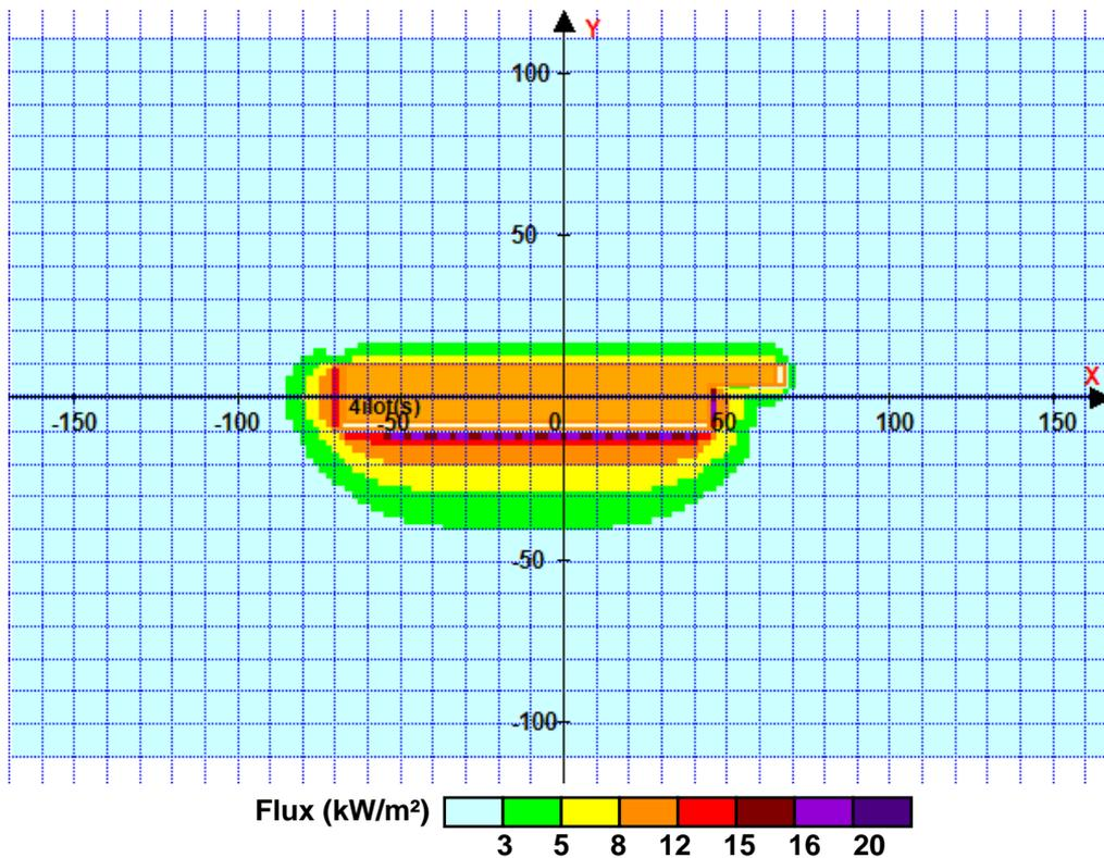
Pour information : Dans l'environnement proche de la flamme, le transfert convectif de chaleur ne peut être négligé. Il est donc préconisé pour de faibles distances d'effets comprises entre 1 et 5 m de retenir une distance d'effets de 5 m et pour celles comprises entre 6 m et 10 m de retenir 10 m.
