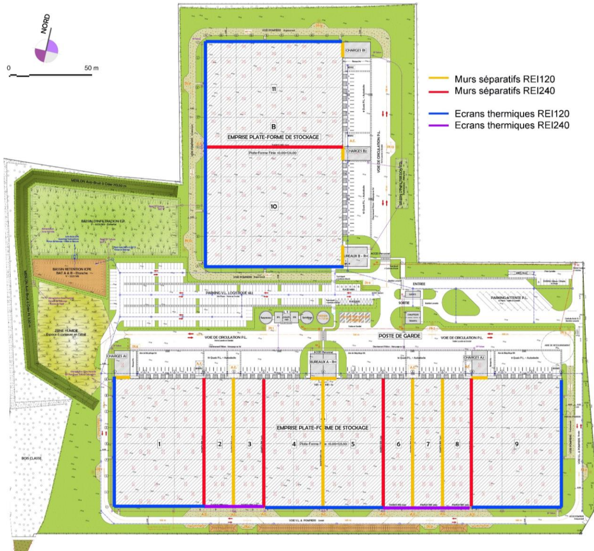
Figure 22 : Localisation des murs séparatifs et écrans thermiques
