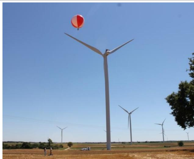
*Mesure de directivité en 3 dimensions avec un sonomètre positionné sur un ballon sonde - Été 2016*
