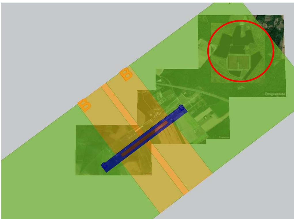
Figure 10 : Repérage des Zones A (■), B (■) et C (■) – Piste RWY 05R-23L
