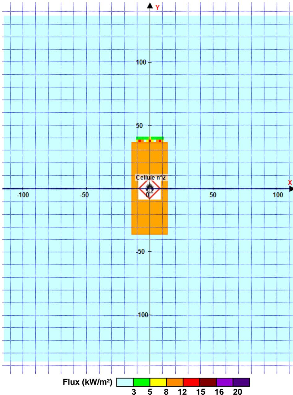
Pour information : Dans l'environnement proche de la flamme, le transfert convectif de chaleur ne peut être négligé. Il est donc préconisé pour de faibles distances d'effets comprises entre 1 et 5 m de retenir une distance d'effets de 5 m et pour celles comprises entre 6 m et 10 m de retenir 10 m.
