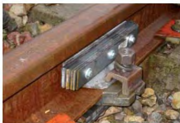
Exemples d'absorbeurs sur rail (Corus et Socitec)
