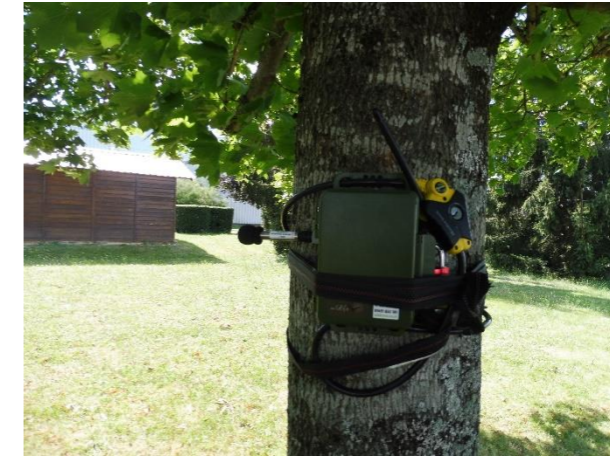
Photo 10 : Pose d'un SM4 sur les emprises du site (©IEA)
