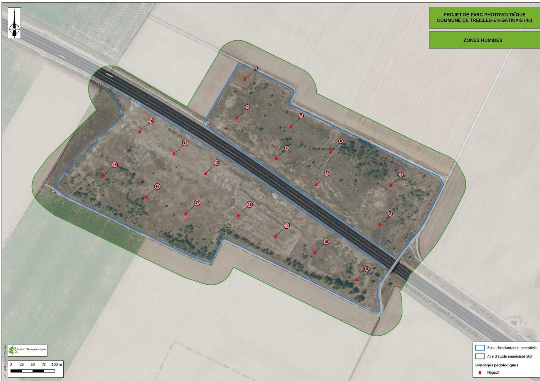
Figure 70 : Localisation et résultats des sondages pédologiques (Source : IEA, 2022)
