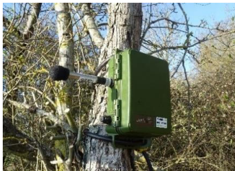
Photo 33 : Détecteur d'ultrasons utilisé lors de l'étude
