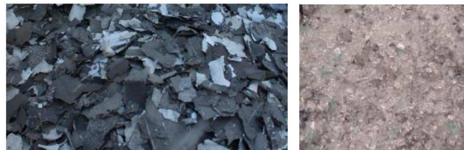
Figure 31 : Fragments de silicium et granules de verre (Source : SOREN)
