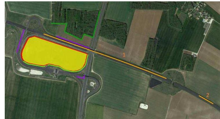
La figure suivante identifie les zones du générateur photovoltaïque qui vont générer ces rayons réfléchis. L'analyse montre qu'environ 84 % de la surface sont à l'origine de ces impacts.
