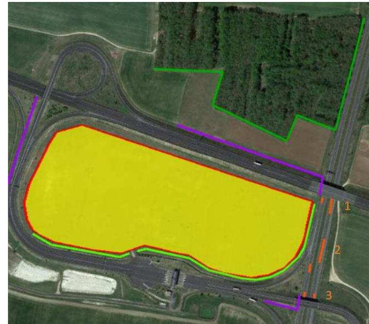
La figure ci-dessous identifie les zones du générateur photovoltaïque qui vont générer ces rayons réfléchis. L'analyse montre qu'environ 35 % de la surface sont à l'origine de ces impacts.
