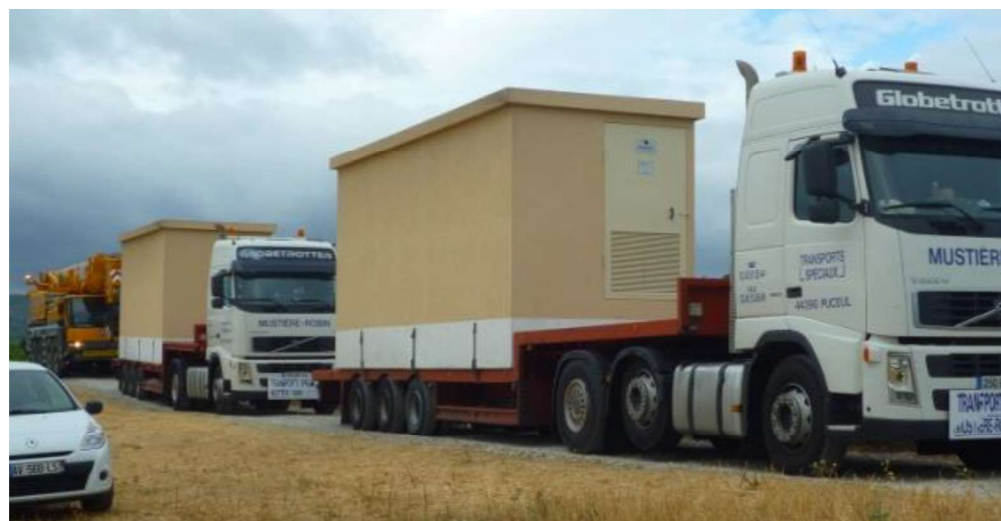
Convoi exceptionnel : Transport des locaux techniques
