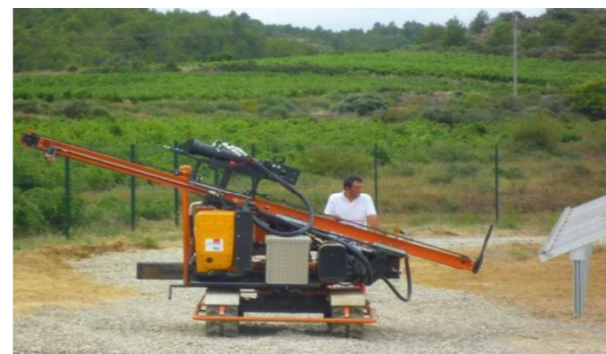
Machine de battage de pieux
