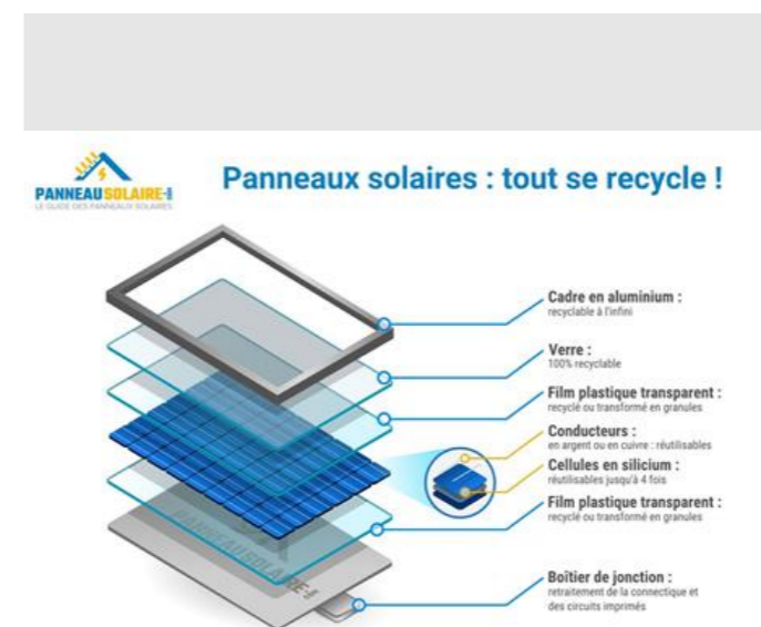
Figure 39 : Les modalités de recyclage des panneaux solaires Source : Panneausolaire.com
