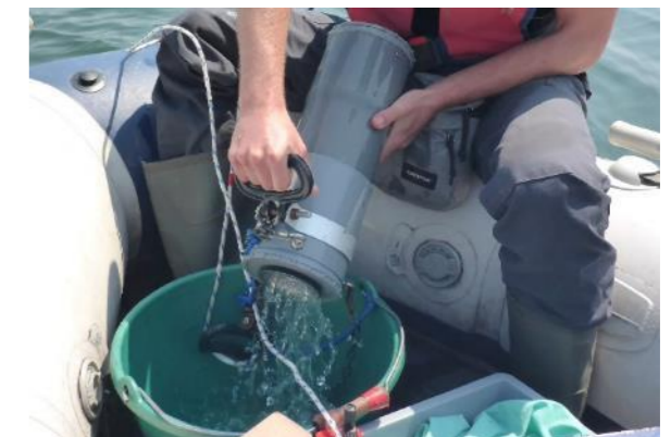
Prélèvements d'eau à la bouteille fermante
