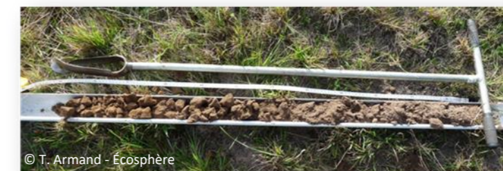
Sondage pédologique à la tarière manuelle
