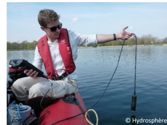
Relevés physico-chimiques à la sonde multi-paramètres
