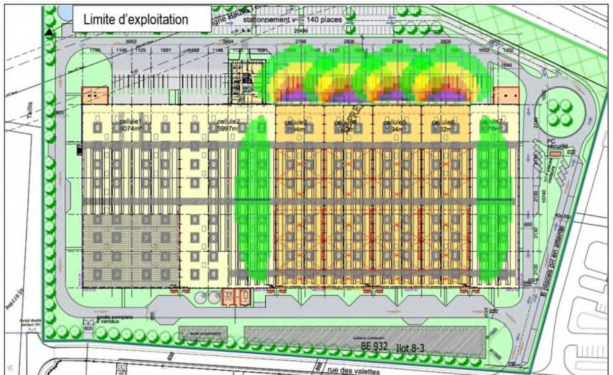
Courbes enveloppe des effets thermiques des stockages de liquides inflammables (hydrocarbures).
