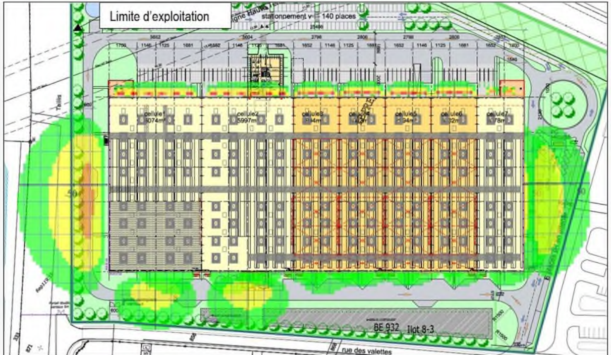
Courbes enveloppe des effets thermiques des stockages de liquides inflammables (hydrocarbures).
